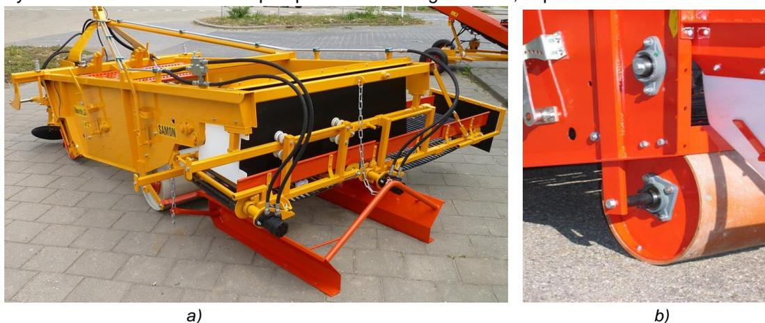
Fig. 2 – Bed-forming device of the disk onion harvester «Samon» (A) and «IMAC» (B) (Holland)
