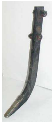
Fig. 1 – The active tillage tool of the ridging machine MB-4 / Scula activă de lucrat solul a mașinii de bilonat MB-4
