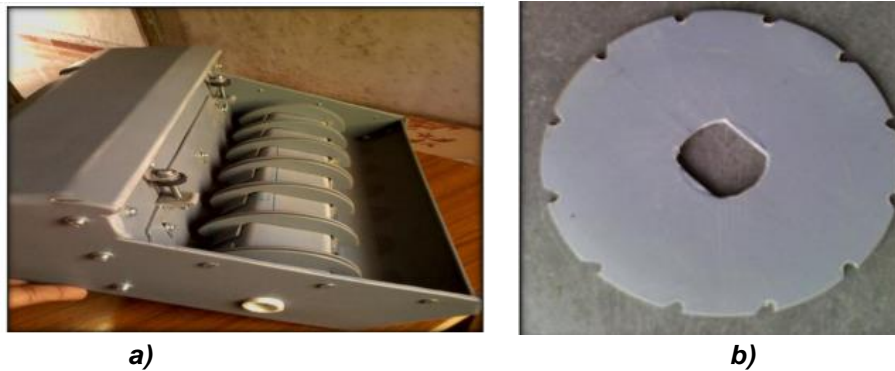
Fig. 1 – Disk sowing machine a) – general view of the sowing device; b) – sowing disk
