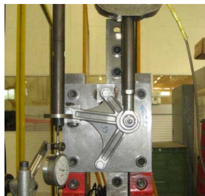
Fig. 4 –The experimental setup for testing on OZ axis/ Montajul experimental folosit pentru incercarea pe axa OZ
