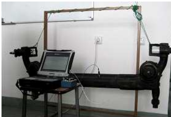
Position of the transducer on the axle / Poziționarea traductorului pe punte
