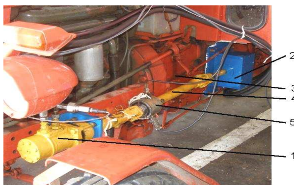
Fig. 1 – Setting the hydrostatic engine and extra gear on the tractor / Amplasarea pe tractor a motorului hidrostatic și a reductorului suplimentar 1 - hydrostatic motor / motor hidrostatic; 2 - extra gear / reductor suplimentar; 3 - tractor gear box / - cutia de viteze a tractorului; 4 - universal transmission / transmisie cardanică; 5 - collector for torque transducer mounted on the drive shaft / colectorul pentru tractorul de cuplu montat pe arborele cardanic
