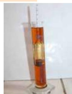
Fig. 1 –Oil density test / Determinarea densității uleiului
