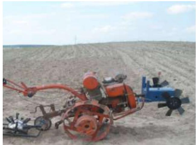
Fig. 5 – Motoblock with an airscrew with a milling cutter / Мотоблок з повітряним гвинтом з ґрунтовою фрезою
