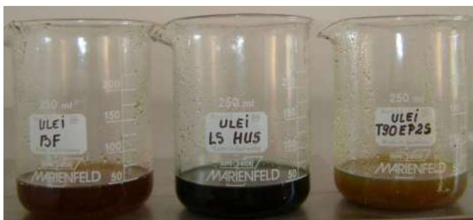
Fig. 8 – Oils polluting with sawdust, fine particles of earth and fine particles of leaves / Infestarea uleiurilor cu: praf de rumeguș; particule fine de pământ și particule fine de frunze
