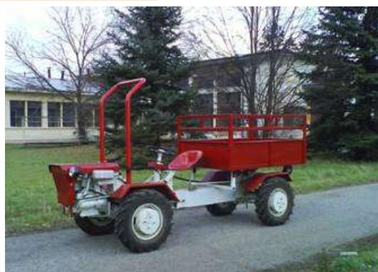
**Fig. 4 - General view of transport vehicle for small farms TK-215T with the newly protective structure / Общ вид на енергетичното транспортно средство за малки земеделски стопанства TK-215T с конструкцията за безопасност**
