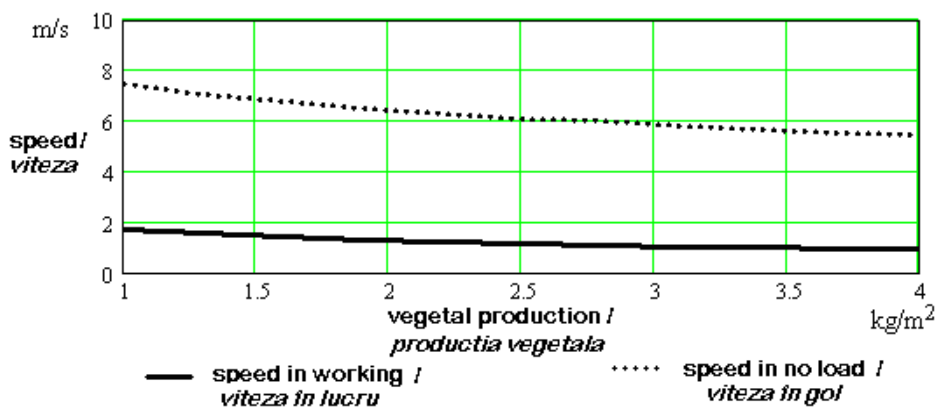
Fig. 7 - Optimal speeds variation with increasing of vegetal production in the case of a route with the length for repairing of mistakes of 15% of length of the road traveled in working / Variația vitezelor optimele cu creșterea producției vegetale în cazul unui parcurs cu lungimea pentru repararea greșurilor de 15 % din lungimea drumului parcurs în lucru
