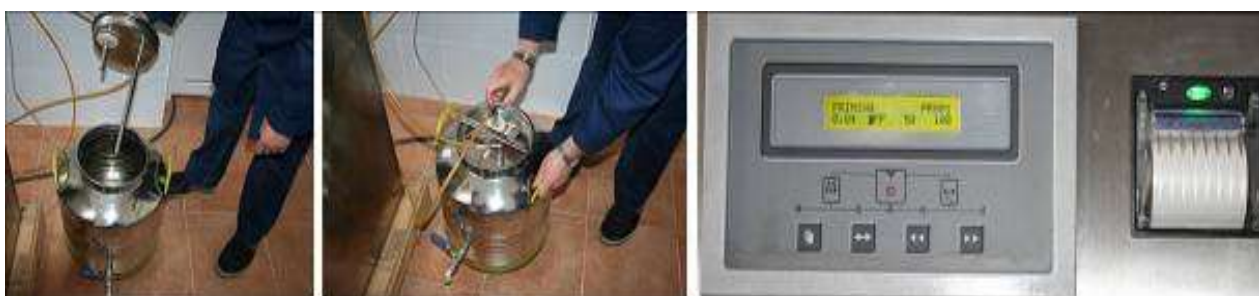
Fig. 6 - Performing the „priming”operation at the beginning of the process, by removing the air with percolator expansion vessel / Realizarea operației de „priming” la începutul procesului, prin eliminarea aerului cu ajutorul vasului de expansiune al percolatorului
