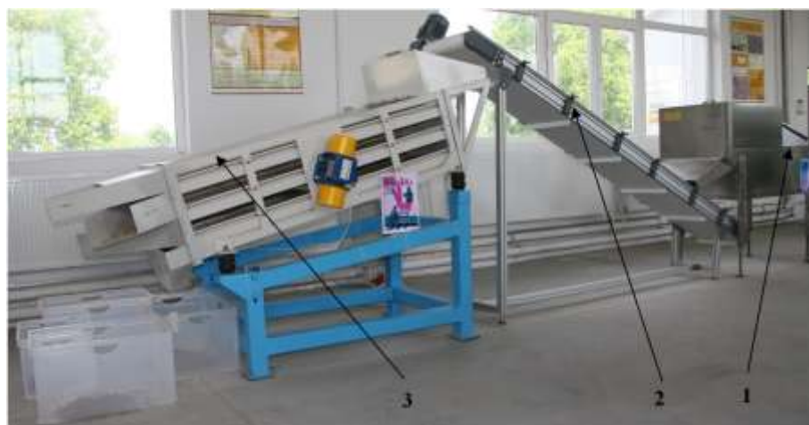
Fig. 1 - Technical equipment designed to medicinal and aromatic plants processing / Echipamente tehnice necesare procesării primare a plantelor medicinale și aromatice [7]
