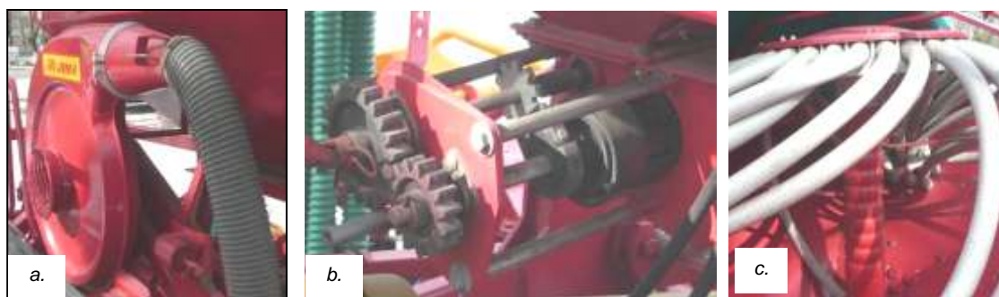
Fig. 1 - The components of the device with centralized dosing and pneumatic distribution / Elementele componente ale aparatului cu dozare centralizată și distribuție pneumatică:
