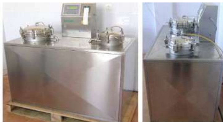
Fig. 2 - Percolator to obtain extracts containing active principles from medicinal and aromatic plants / Percolator pentru obținerea de extracte care conțin principii active din plante medicinale și aromatice [7]
