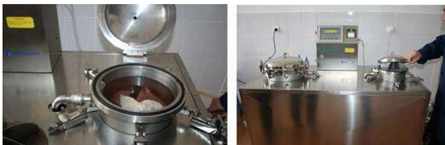
Fig. 5 - a) Filling the solvent compartment up to the suitable level / Umplerea compartimentului cu solvent până la nivel; b) Closing and clenching the cover of percolating installation / Închiderea și strângerea capacului compartimentului de percolare
