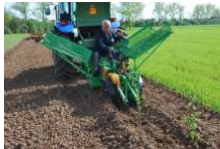
Fig. 5- Equipment of planting forestry seedlings, EPF1 / Echipament de plantat puieți forestieri--EPF1--în lucru
