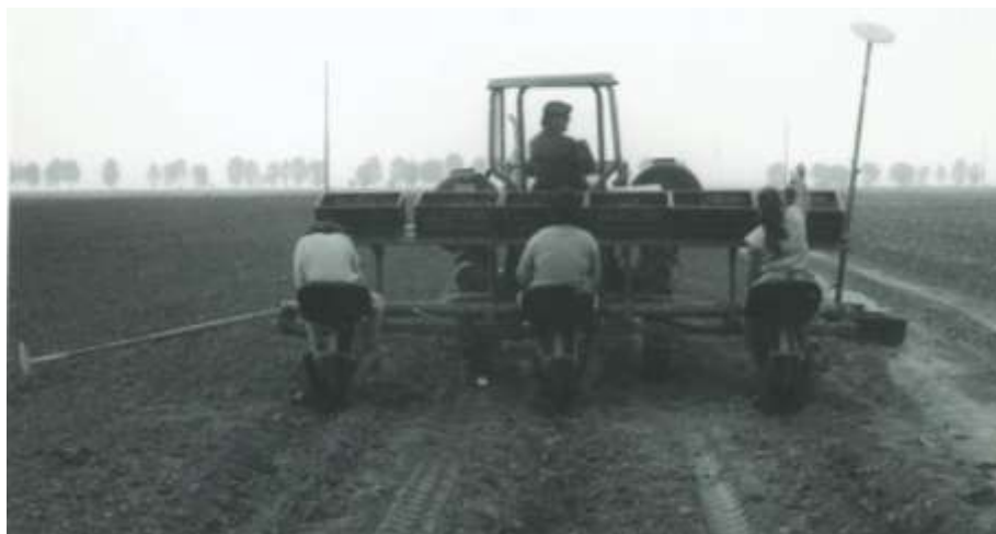
Fig. 4 - Planting machine PLANT, during the work / Mașina de plantat PLANT, în lucru
