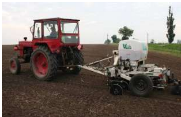
Fig. 1 - The electro-conductivity soil mapping system VERIS 3150 with electro-conductivity sensors (center) / Sistemul pentru cartarea electro-conductivității solului VERIS 3150 cu senzorii de electro-conductivitate (centru)
