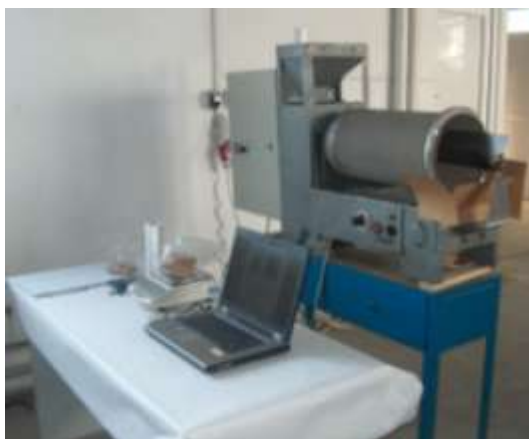
Fig. 2 – Stand for investigation of the working process of the indented cylinder separators / Stand pentru investigarea procesului de lucru al Trioarelor cilindrice
