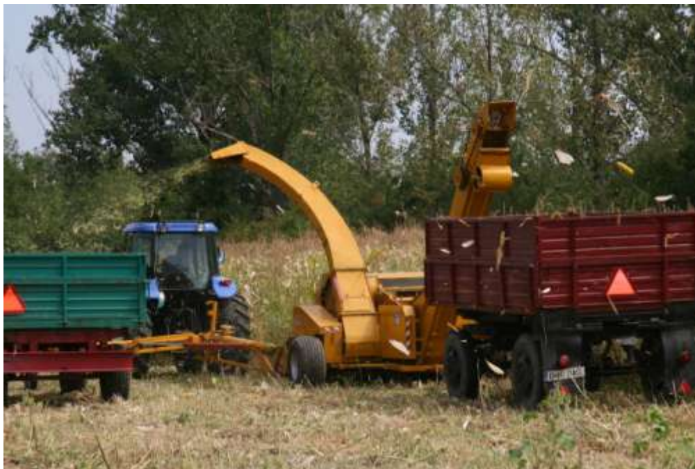
Fig. 5 - Sweet corn harvesting combine during the work, when the chopped matter is thrown on the soil / Combina de recoltat porumb zaharat în lucru varianta cu materialul tocat deversat pe sol
