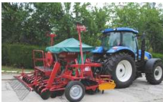
Fig. 3 - Technical equipment endowed with working parts for preparing the soil and sowing straw cereals / Echipament tehnic cu organe de lucru pentru pregătīt solul și semănat cerealele păioase
