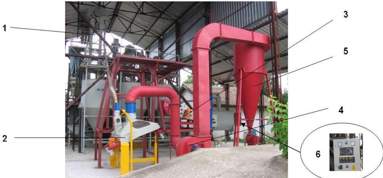
Fig. 1 - Cereal primary processing module MPPC-0 mounted on installation platform – milling installation ICM of INMA Bucharest / Modulul de prelucrare primară a cerealelor MPPC-0 montat pe platforma instalației – școală de măcinat ICM a INMA București 1 - elevator / elevator; 2 - gravity separator / separator gravitațional; 3 - intensive separator - suction apparatus / separator aspirator intensiv; 4 - ventilator / ventilator; 5 - cyclone collector / ciclon desprăfuire; 6 - control and signalling board / tablou de comandă și semnalizare
