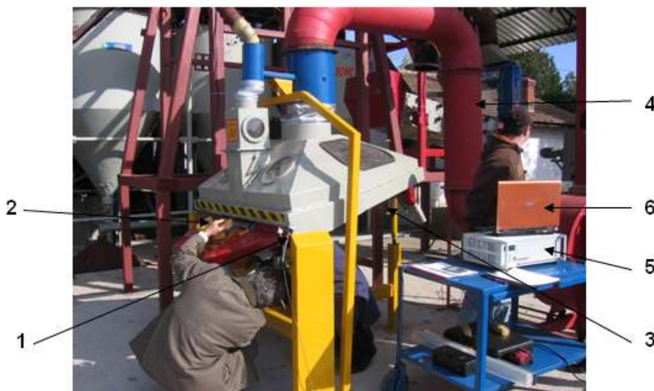
Fig. 3 Place of measuring apparatus and adjusting area / Modul de amplasare al aparaturii de măsură și zone de reglare 1 - displacement transducer / traductor de deplasare ; 2 - counterweights / contragreutati ; 3 - screw mechanism / mecanism cu surub ; 4 - suction conduit / tub de aspirație ; 5 - module of amplifying and data acquisition / modul de amplificare și achiziție date ; 6 - laptop / laptop
