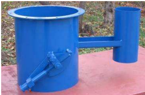
Fig. 12 – Suction conduit and valve adjusting mechanism / Conductă de aspirație și vedere mecanism reglare clapetă
