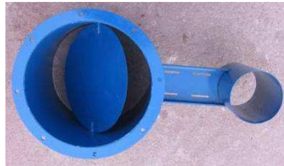
Fig. 12 – Suction conduit and valve adjusting mechanism / Conductă de aspirație și vedere mecanism reglare clapetă
