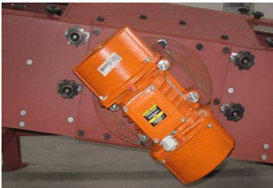
Fig. 5 - Position of electrovibrator on the body / Poziționare electrovibrator pe batiu
