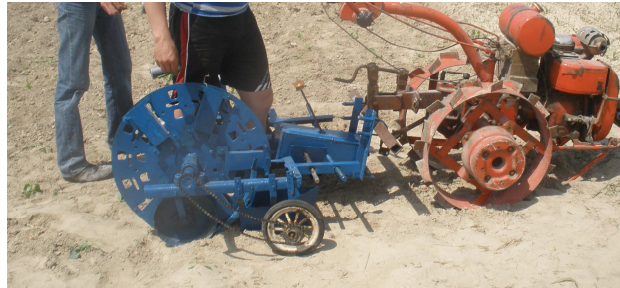
Fig. 1 – Motoblock with machine for planting seedlings with sections that moves in lateral direction / Мотоблок з розсадосадильною машиною з секціями, які переміщуються в боковому напрямку
