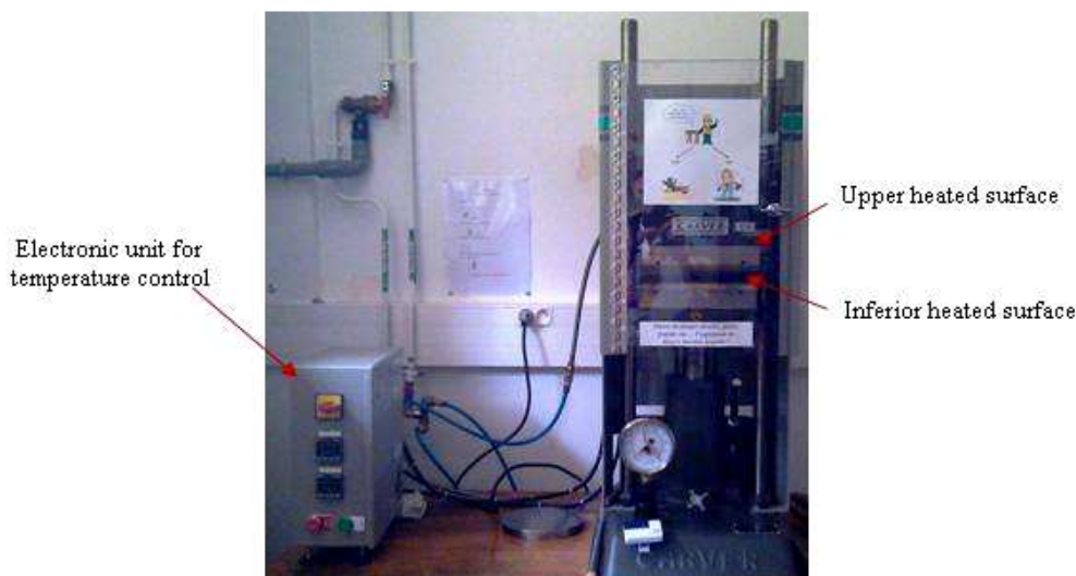
Fig. 2 - Compression moulding machine used to form the test bars / Masina de formare prin comprimare utilizata la realizarea barelor de testare
