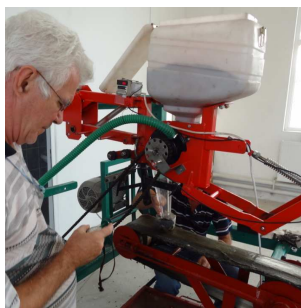
Fig. 2 - Stand with fixed mounted sowing body / Stand cu secția de semănat montată fix
