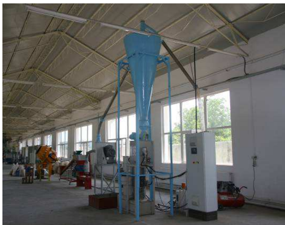
Fig. 6 – Integrated technological line of obtaining pellets and agripellets / Linie tehnologică integrată de obținere pelete și agripellete
